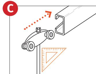
Introduire le porte-galets rivé sur la barre de réglage à l'intérieur, par l'extrémité restée libre. Bloquer le support-boîtier sur la tige de réglage porte-galets à l'aide des deux vis à la hauteur nécessaire. La tige de réglage doit être perpendiculaire à la barre.
