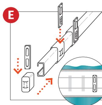
Quand l'appareil est définitivement posé, introduire les pièces coulissantes en les faisant glisser par l'extrémité restée libre de la barre. Placer l'embout enjoliveur à l'extrémité de la barre. Cet embout sert aussi de butoir aux pièces coulissantes. Les agrafes s'accrochent directement sur la ruflette de la tenture.
