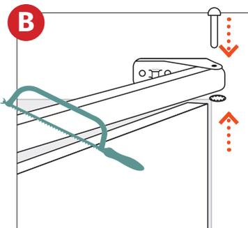
Une fois la charnière posée, mettre en place la barre au moyen de l'axe sur le support charnière. Si besoin, couper cette barre à votre mesure (largeur de la porte) à l'aide d'une simple scie à métaux.
