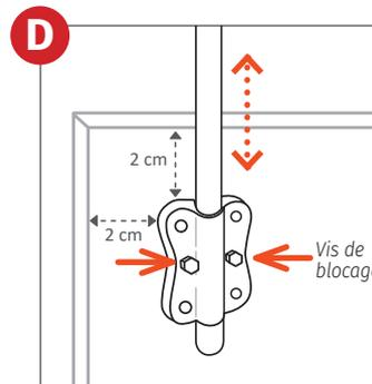
Le support-boîtier papillon doit être installé sur la porte à environ 2 cm des deux bords de l'angle supérieur de la porte. Ajuster en faisant coulisser la tige de réglage porte-galets dans le support-boîtier de porte. Fixer le support-boîtier sur la porte avec 4 vis. Couper la tige verticale le plus près possible du boîtier. La longueur à couper dépend de l'emplacement du support-boîtier. Resserrer complètement les 2 vis de blocage.
